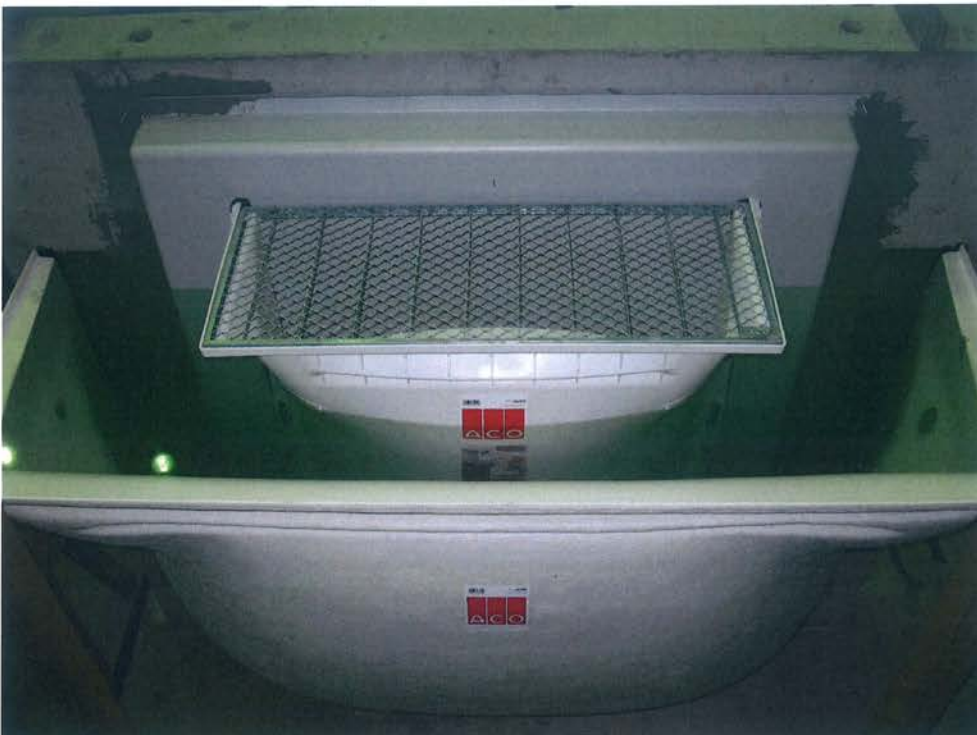
Bild 12: Füllung des äußeren Lichtschachtes während der 28-tägigen Dichtheitsprüfung
