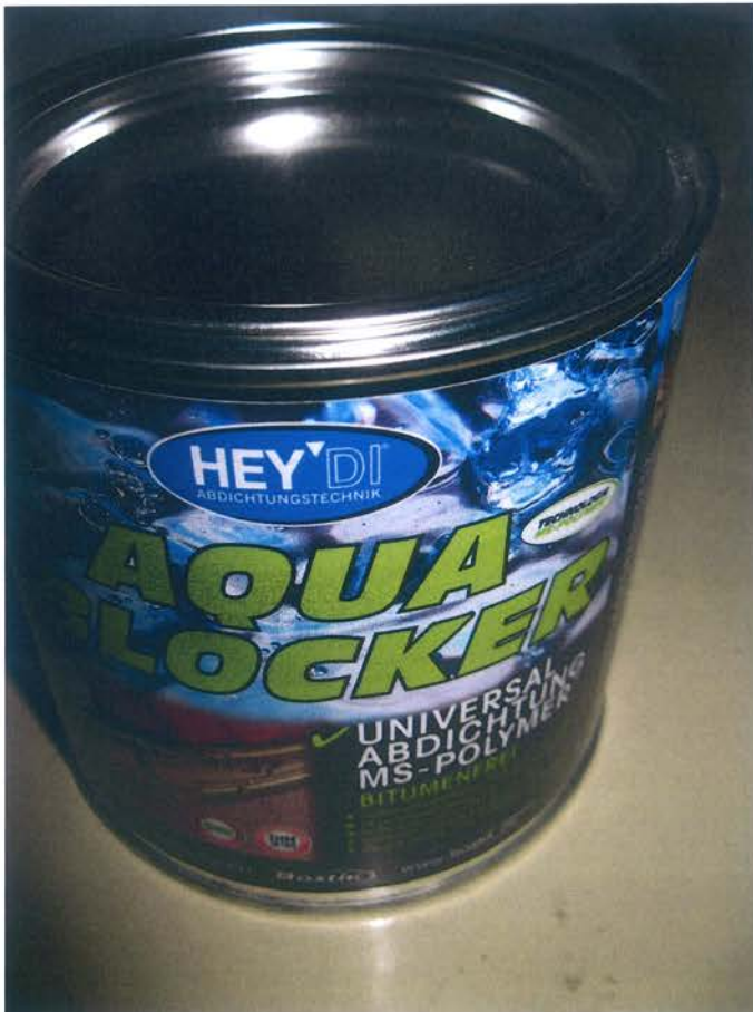
Bild 5: Zur Abdichtung des Montageplatten-Flansches verwendetes MS-Polymer AQUA BLOCKER
