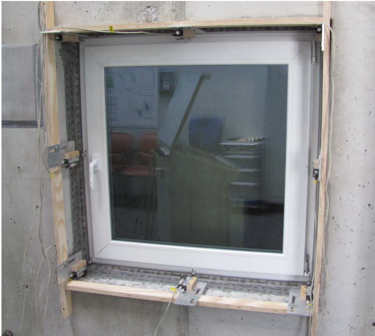
Bild 1 Probekörperansicht von der Raumseite mit angebrachten Verformungsaufnehmern
