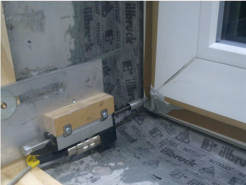
Bild 4 Raumseitige Ansicht untere ECKAusbildung mit raumseitiger Abdichtung
