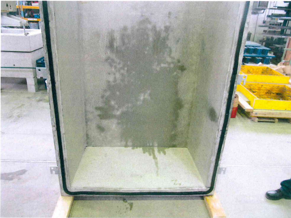
Bild 1: Stahlbetonlichtschacht zum Aufstauen des Wassers
