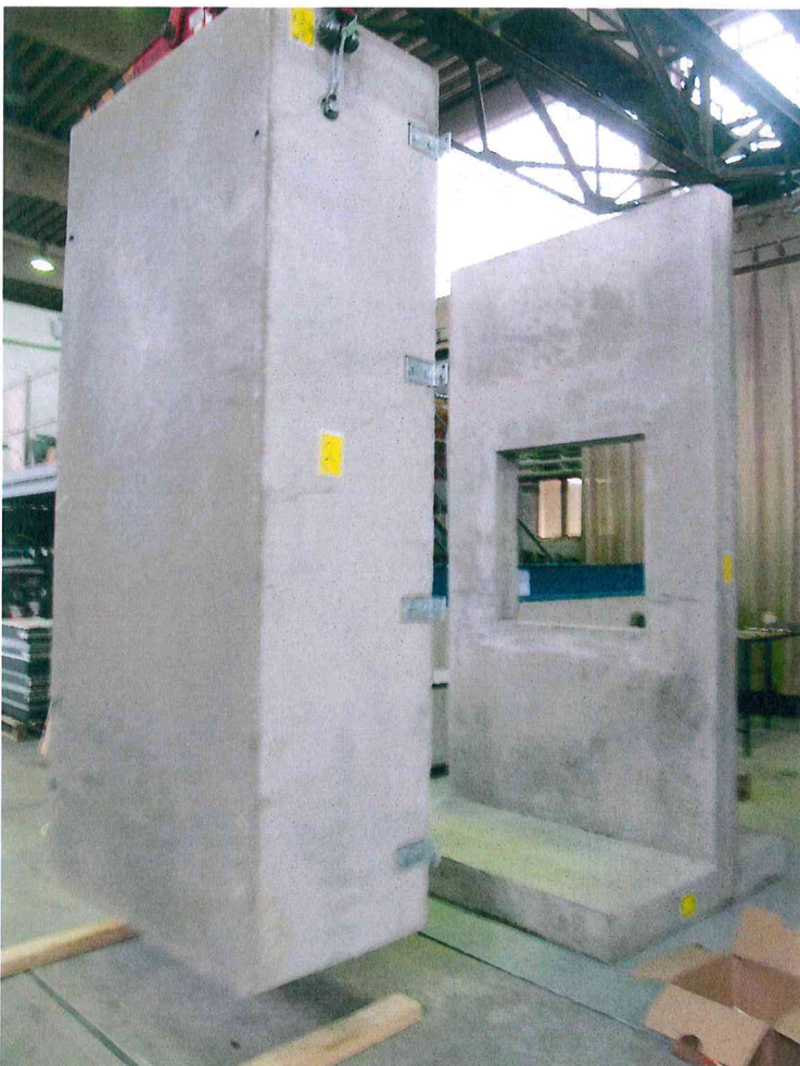
Bild 1: Stahlbetonlichtschacht zum Aufstauen des Wassers
