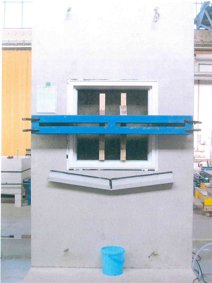
Bild 8: ACO Therm® 3.0 HWD-S plus während der Wasserbeaufschlagung ohne erkennbaren Wassereintritt
