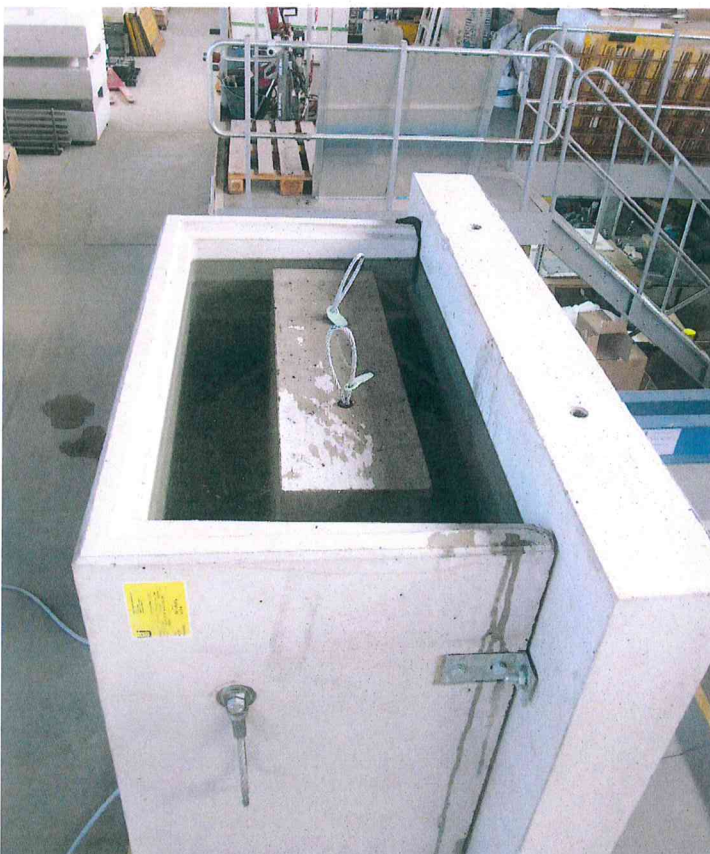
Bild 7: Wasserfüllung bis 2 m über OK Bezugsebene (=OK Fensterbrüstung)
