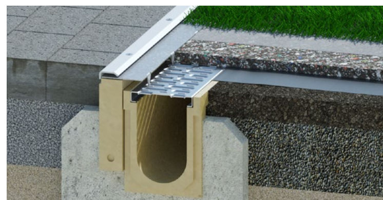
Beispiel einer Unterflurentwässerung von polgefülltem Kunstrasen auf Dränageplatten
