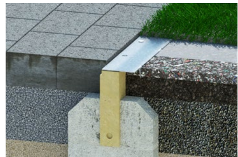
Einfassungsbord für Kunstrasen als Bord mit Krallschiene für Shockpad-Komponenten
