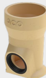
D 400 Ablaufkörper Langform in Verbindung mit Oberteil, mit Anschluss für KG-Rohr DN/OD 110, mit Lippen- labyrinthdichtung Art.-Nr. 319605
