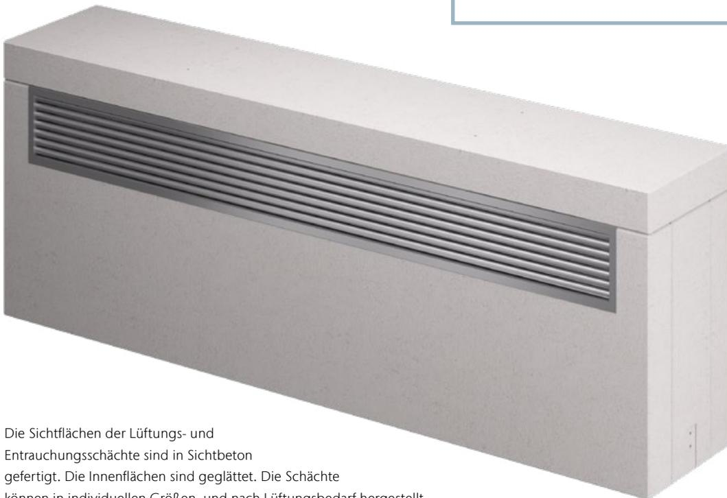
Die Sichtflächen der Lüftungs- und Entrauchungsschächte sind in Sichtbeton gefertigt. Die Innenflächen sind geglättet. Die Schächte können in individuellen Größen und nach Lüftungsbedarf hergestellt werden. Für die Verschraubung des Schachtes mit dem Untergrund sind zwei Montagebereiche vorgesehen.
