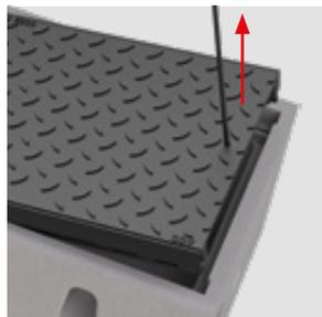
Rosthaken vertikal anheben und Abdeckplatte ausheben.
