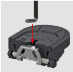
**Öffnen:** Rosthaken oder gleichwertiges Hilfsmittel mittig in Öffnung einführen und Arretierung hinunterdrücken.
