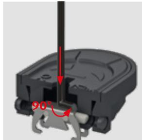
Rosthaken hinuntergedrückt halten und um 90° drehen, sodass der Rosthaken in der Composite-Kunststoffabdeckung arretiert ist.
