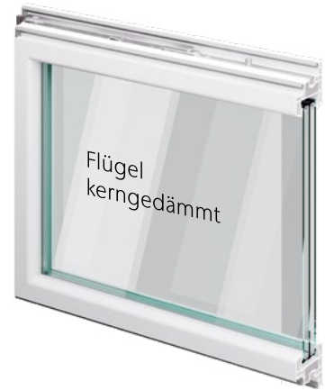
3-fach Wärmeschutzverglasung Ug-Wert = 0,6 W/(m 2 K) passivhaustauglich
