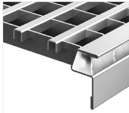
Designrost Längsprofil, Edelstahl oder Stahl verzinkt, begebar bis 1,5 kN
