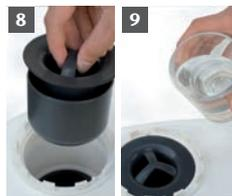
**Optional:** Der Geruchsverschluss (Art.-Nr. 310073) kann separat bestellt werden. Beim Rückstauverschluss (Art.-Nr. 310060) ist der Geruchsverschluss im Lieferumfang enthalten. Beim Einsatz der Rückstaeinheit muss der Geruchsverschluss zwingend eingesetzt werden. Den Geruchsverschluss mittig und gerade auf den Befestigungsring setzen und dann ca. 2–3 mm niederdrücken, bis die Dichtlippe arretiert. Anschließend mit Wasser befüllen.
