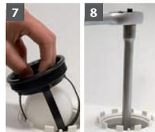
7 Die Rückstaeinheit von oben in den Grundkörper führen. Hierbei ist ein leichter Widerstand zu überwinden, wenn der Kugelkäfig durch die Einschnürung im Grundkörper geschoben wird. Dabei nicht drehen! Beim Einschrauben auf den korrekten Sitz des Gewindes achten. Drehmoment: 5 Nm
