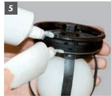
5 Nach dem Reinigen alle Dichtungen auf Reinheit und Beschädigungen untersuchen. Beschädigte oder fehlende Dichtungen führen zur Fehlfunktion der Rückstaeinheit. Beschädigte Dichtungen austauschen! Dichtungen an der Rückstaeinheit mit Gleitmittel bestreichen (wie bei Montage).
