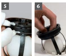
**Beim Einsatz der Rückstaeinheit:** Das Innengewinde des Grundkörpers gegebenenfalls von Verunreinigungen befreien. Den O-Ring und die Dichtlippe am unteren äußeren Rand der Rückstaeinheit dünn mit Gleitmittel bestreichen. Die Rückstaeinheit von oben in den Grundkörper führen. Hierbei ist ein leichter Widerstand zu überwinden, wenn der Kugelkäfig durch die Einschnürung im Grundkörper geschoben wird. Dabei nicht drehen!
