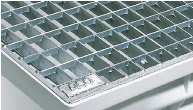
Maschenrost, Maschenweite 30 x 30 mm, begehbar bis 1,5 kN
