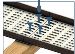
4. Rinnenstrang mit Unterkonstruktion verschrauben
