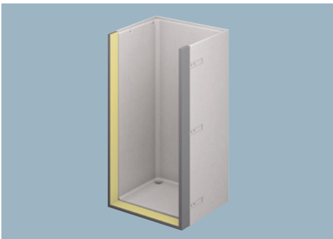
Betonlichtschacht in druckwasserdichter Ausführung in Sonderbauhöhe, mit werkseitig aufgebracht er Dämmung und bei Bedarf mit zusätzlichem Befestigungsbereich
