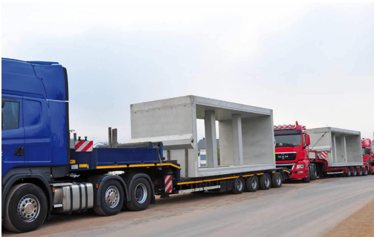
Transport des Großbehältersystems
