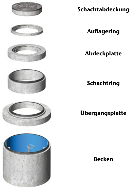
Beispielhafter Schachtaufbau
