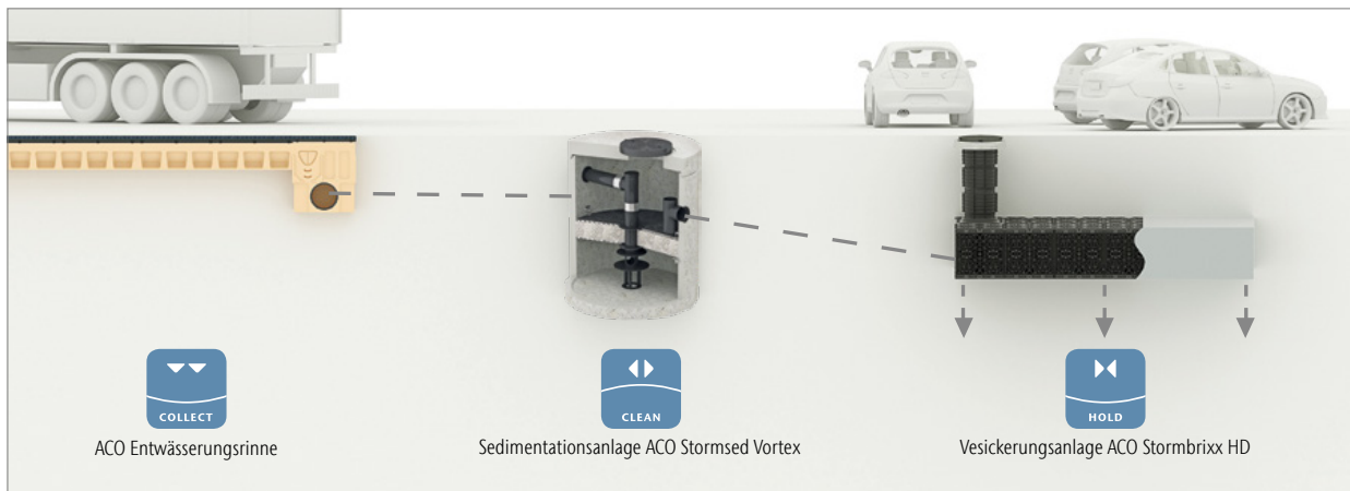
ACO Systemkette für eine Regenwasserversickerung mit ACO Stormbrixx
