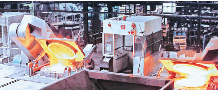
Moderne Mittelfrequenz-Induktions-Schmelzöfen, ACO Kaiserslautern
