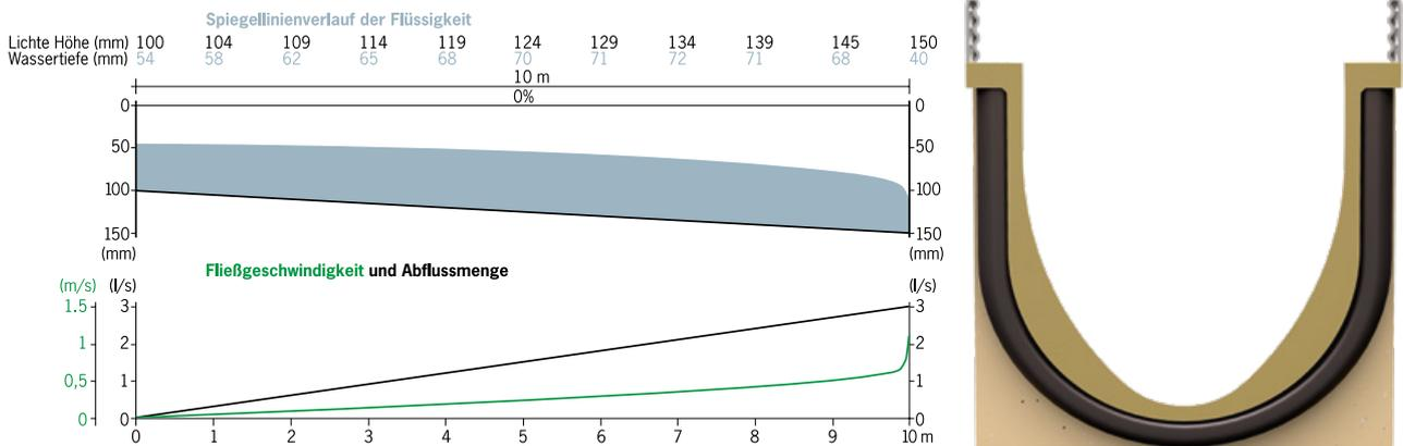
Der V-Querschnitt – verbesserte Hydraulik und Stabilität
