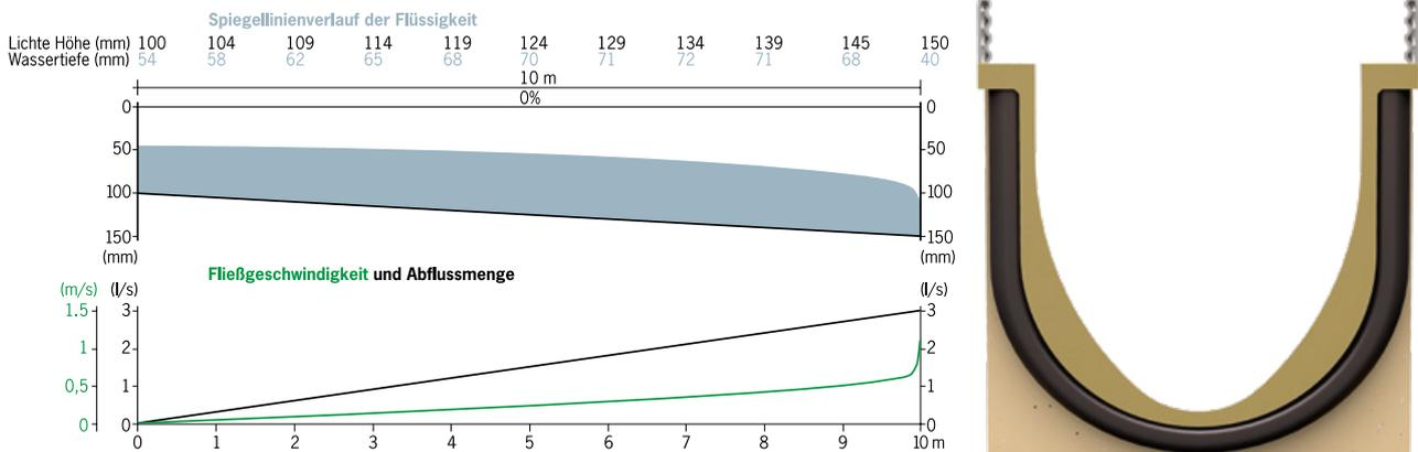
Der V-Querschnitt – verbesserte Hydraulik und Stabilität
