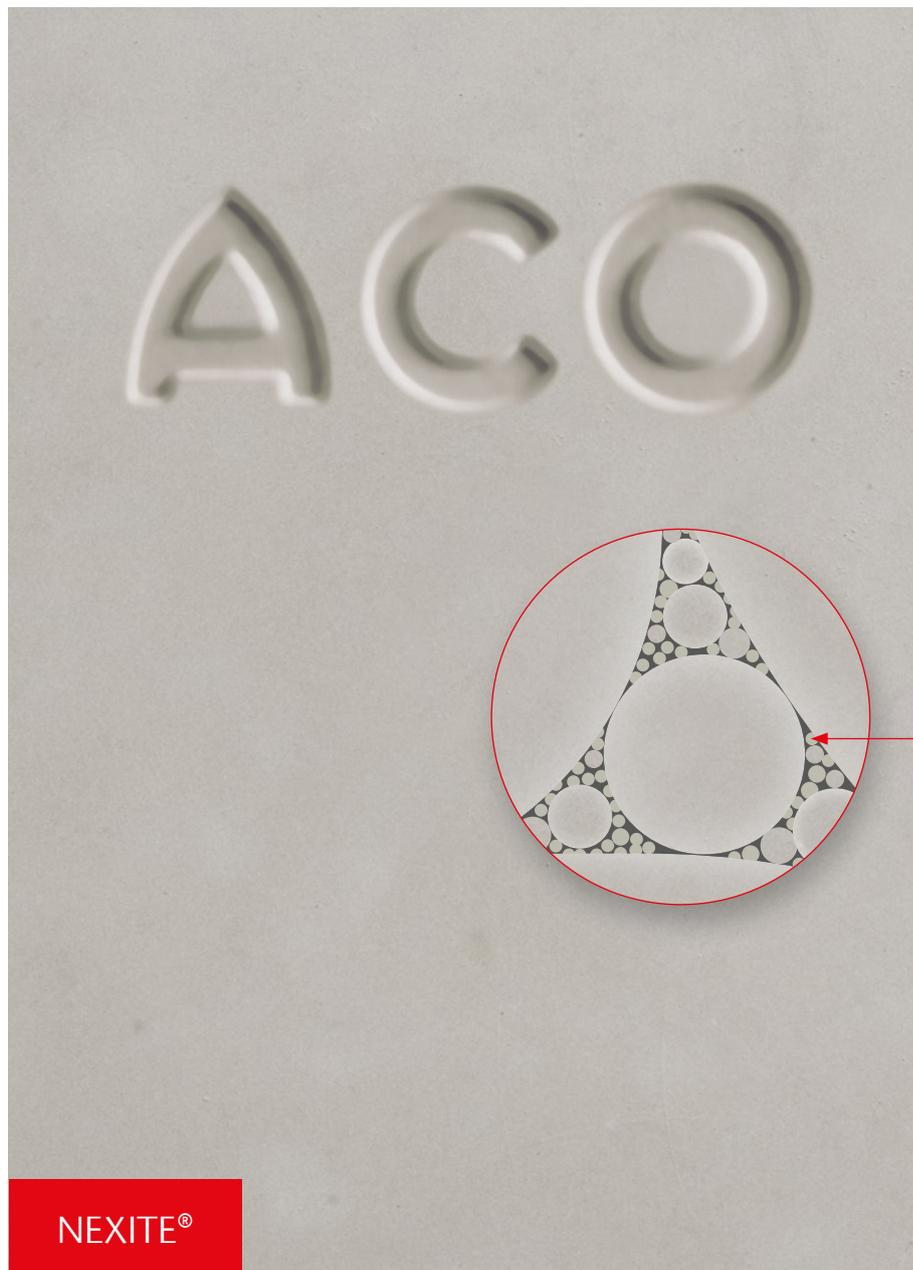
■ mineralische Feinstfüllstoffe mit optimaler Packungsdichte
