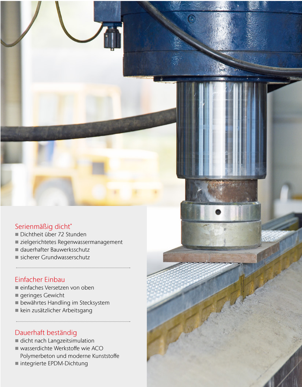
Prüfung der Dichtheit nach Langzeitsimulation
