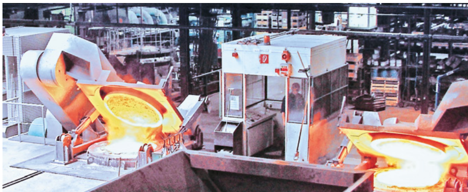
Moderne Mittelfrequenz-Induktions-Schmelzöfen, ACO Kaiserslautern
