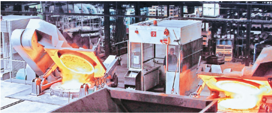
Moderne Mittelfrequenz-Induktions-Schmelzöfen, ACO Kaiserslautern
