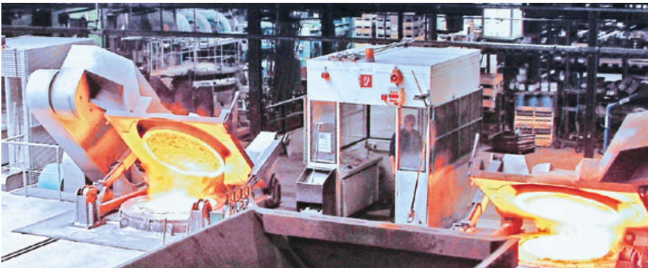
Moderne Mittelfrequenz-Induktions-Schmelzöfen, ACO Kaiserslautern
