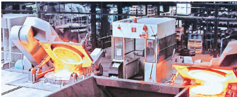
Moderne Mittelfrequenz-Induktions-Schmelzöfen, ACO Kaiserslautern
