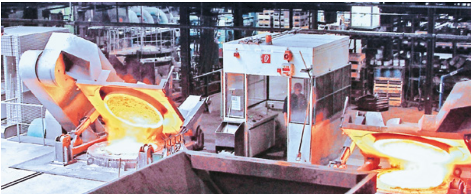
Moderne Mittelfrequenz-Induktions-Schmelzöfen, ACO Kaiserslautern
