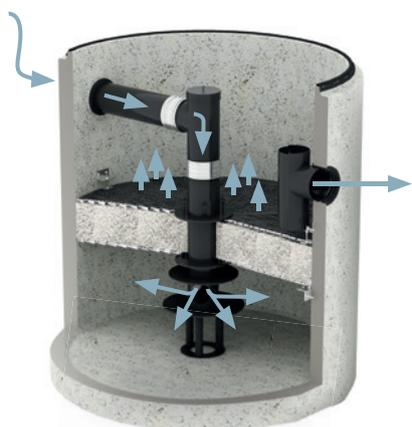
Verkehrs- und Sportflächen können Quellen der Niederschlags- und Gewässerverschmutzung durch ausgeschwemmtes Gummi-Granulat, Reifen- und Metallabrieb, Feinstaub oder organische Verunreinigung sein. Der ACO SPORT® Filtrationsschacht reinigt anfallende Wassermengen aus Niederschlägen oder Beregnungsanlagen effektiv von diesen Verschmutzungen. Anschließend kann das Wasser in die Kanalisation, Versickerungsanlage oder einen Sammel-tank zur Wiederverwendung geleitet werden.
