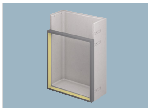
Betonlichtschacht in druckwasserdichter Ausführung mit umlaufend aufgebrachten Dämmrahmen zum Aufstellen einer Hinterfüllplatte und zusätzlichem Befestigungsbereich zur Verschraubung der Hinterfüllplatte mit dem Schacht
