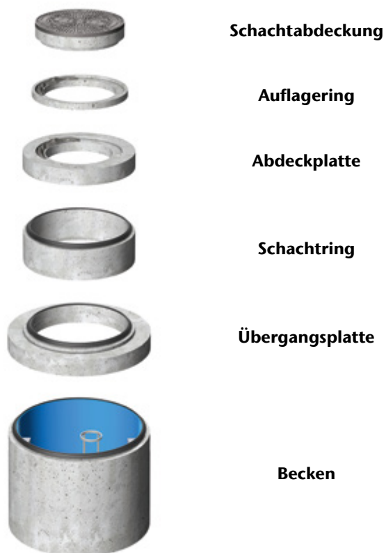
Beispielhafter Schachtaufbau
