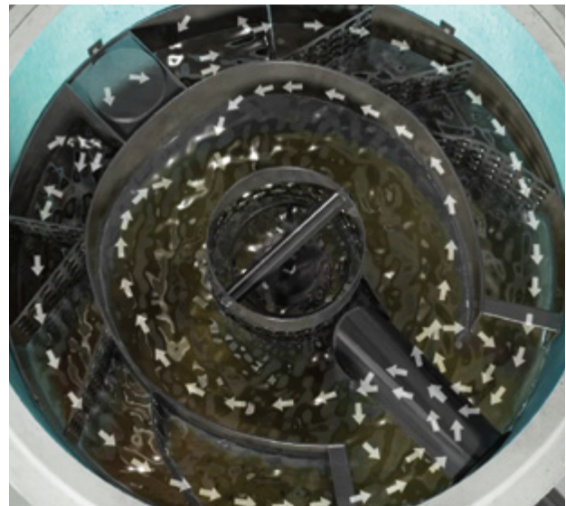
Feinseparation durch lange Fließstrecke
