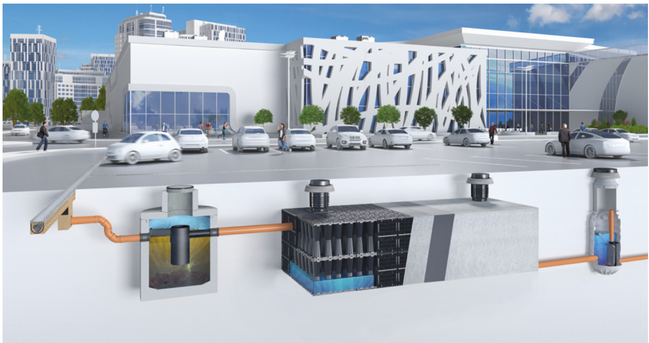
ACO Sedimentationsanlage vor Rigolensystem ACO Stormbrixx einschließlich geregelter Abgabe über einen ACO Drosselschacht
