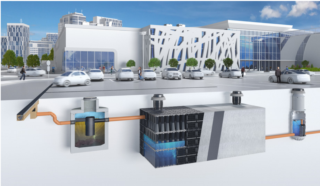
ACO Sedimentationsanlage vor modularem Rigolensystem ACO Stormbrixx mit geregelter Abgabe über einen ACO Drosselschacht
