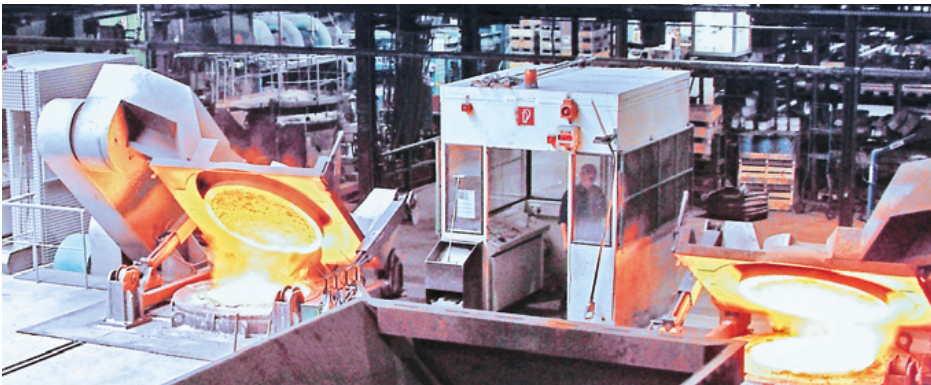
Moderne Mittelfrequenz-Induktions-Schmelzöfen, ACO Kaiserslautern
