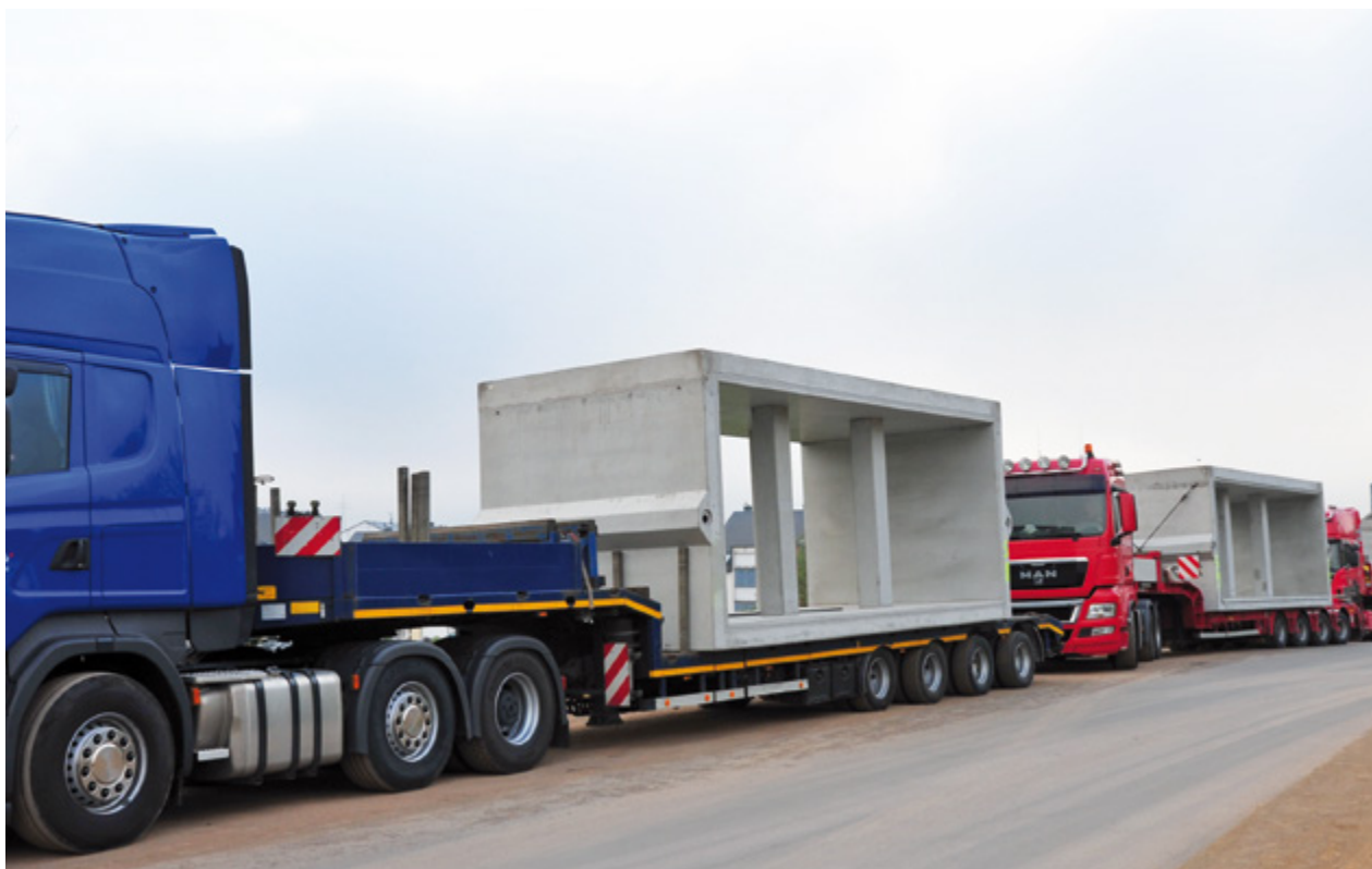
Transport des Großbehältersystems
