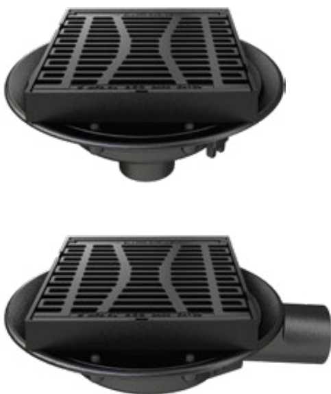
ACO Brückenablauf Multitop HSD-5 Kennmaß 500 x 500 aus Gusseisen Klasse D 400 nach DIN EN 124
