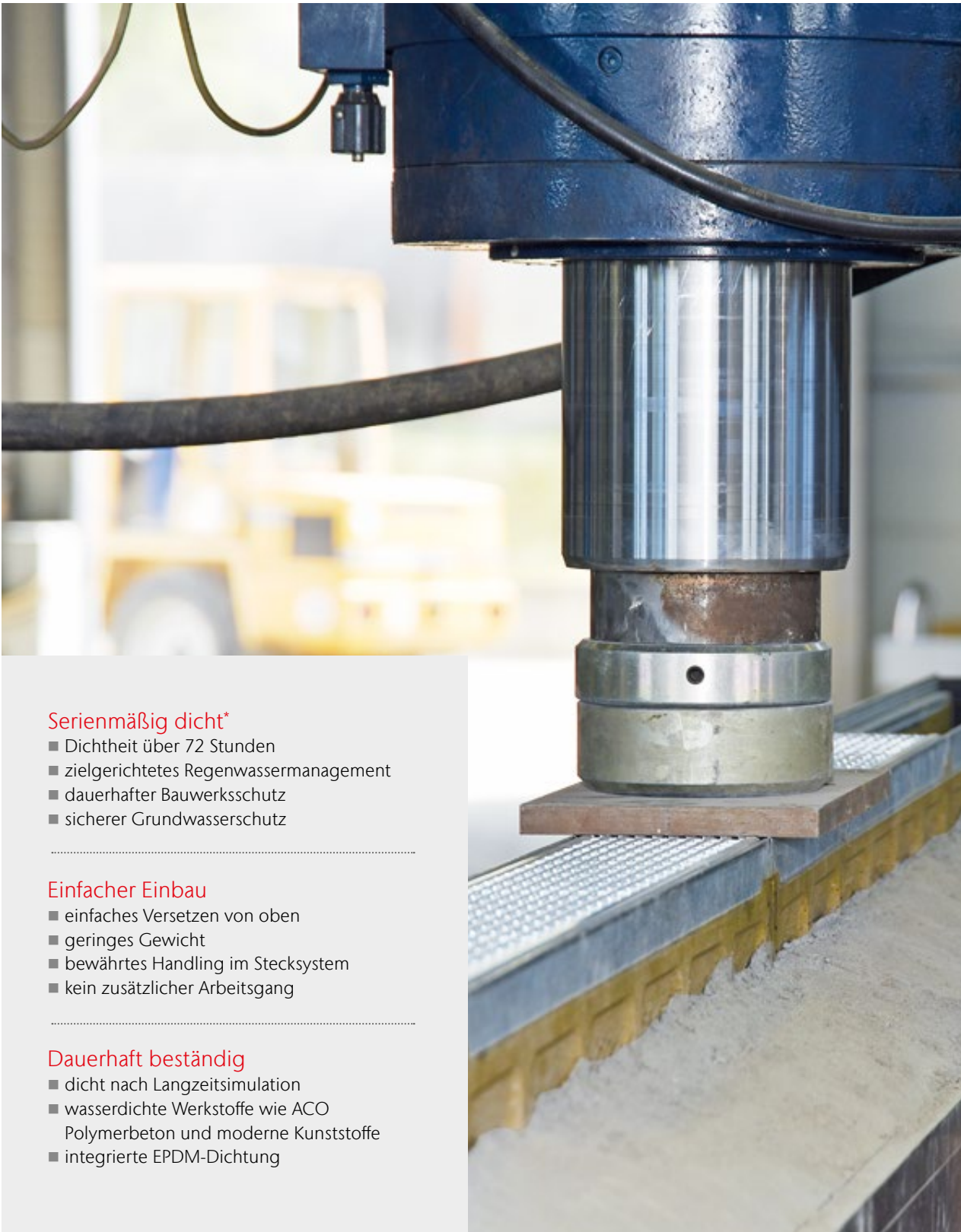
Prüfung der Dichtheit nach Langzeitsimulation
