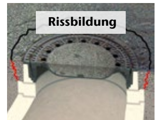
Durch Schwingungen erzeugte Risse an herkömmlichen Schachtabdeckungen
