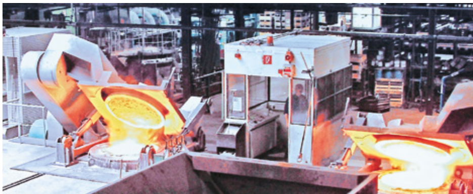
Moderne Mittelfrequenz-Induktions-Schmelzöfen, ACO Kaiserslautern
