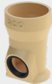
Ablaufkörper Tief/Rund in Verbindung mit Oberteil, mit Anschluss für KG-Rohr DN/OD 110, mit Lippen- labyrinthdichtung Art.-Nr. 319605
