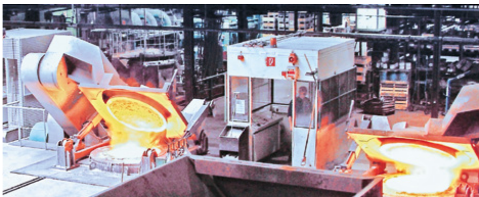
Fours de fusion modernes à moyenne fréquence Fours de fusion à induction, ACO Kaiserslautern
