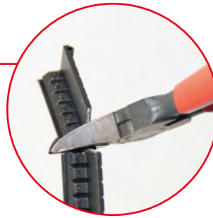
bei Bedarf mit Seitenschneider kürzen
