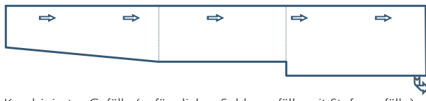
Kombiniertes Gefälle (anfängliches Sohlgefälle mit Stufengefälle)
