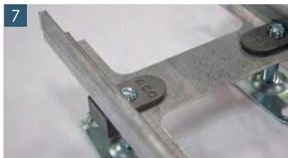
7 Nach dem Einsetzen von min. 4 Füßen kann die Frameline verbaut werden
