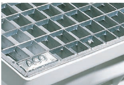
Maschenrost, Maschenweite 30 x 30 mm, begebar bis 1,5 kN
