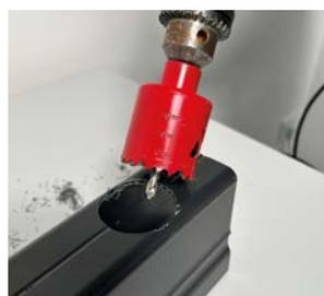
Lochsäge auf Bohrmaschine setzen und Öffnung an der Stelle schneiden, an der der Ablaufstützen platziert werden soll
