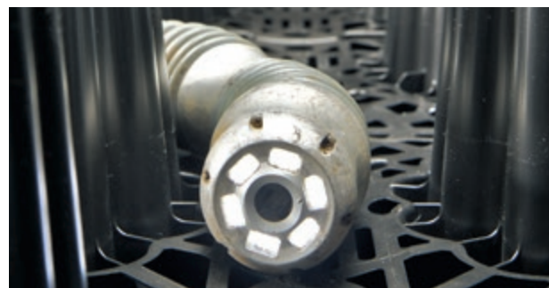
Schiebekamera, Reinigungsgerät mit Spülkopf
