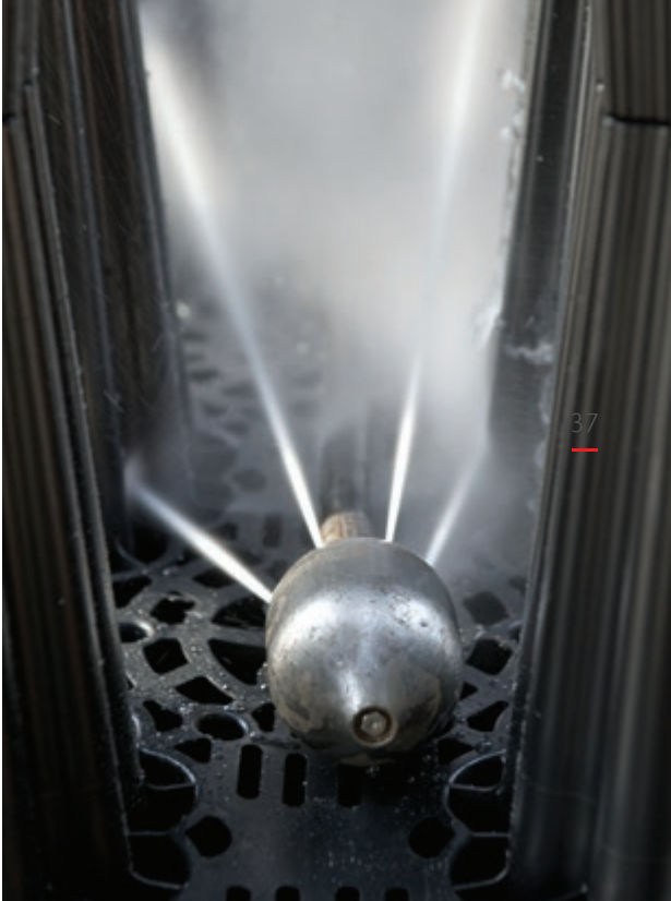
Reinigungsgerät mit Spülkopf. Die Druckspülung und das Absaugen eventueller Absetzungen sind zeitgleich möglich.
